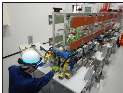
分岐器模型を使用した故障対応教育
