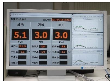
風向風速監視システム
